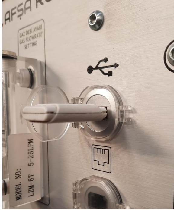
Resim 3.1.1 USB ile PCCL Yükleme ve Backup Alma İşlemi
